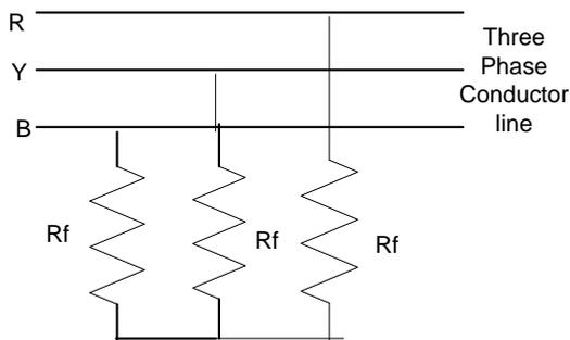
(d) Symmetrical Three Phase Fault (L-L-L)
